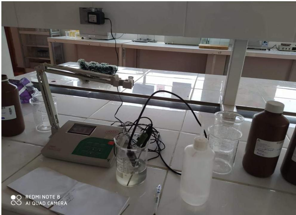
**Figura 34:** análisis en laboratorio del pH.
